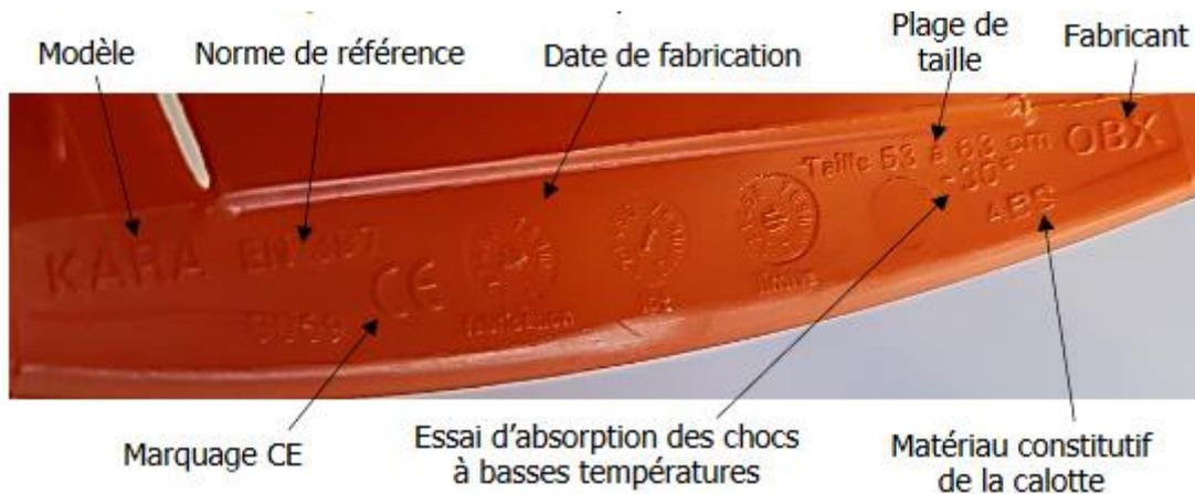
La durée de vie des casques de sécurité est liée aux matériaux qui les constituent, à leurs conditions d'emploi et à la qualité de leur entretien. Suivant les matériaux, les casques seront plus résistants aux produits chimiques, aux UV, aux déformations thermiques ou au vieillissement (Voir notice du fabricant + pastille « durée de vie »)
