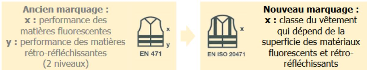
Le chiffre à côté du pictogramme (x) indique la catégorie de l'article en fonction d'une surface minimale de matériau fluorescent et rétro-réfléchissant utilisé. Le classement dans une catégorie nécessite que les deux valeurs minimales soient atteintes :
